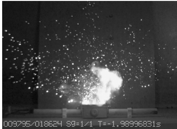
Rys. 13. Skutki oddziaływania elektrodynamicznego podczas przepływu prądu zwarcowego. Zdjęcie przed i po próbie zwarcowej.
